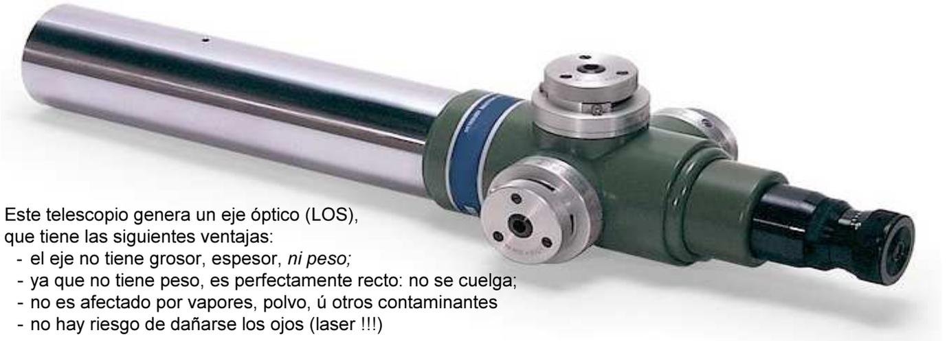
Este telescopio genera un eje óptico (LOS), que tiene las siguientes ventajas:
