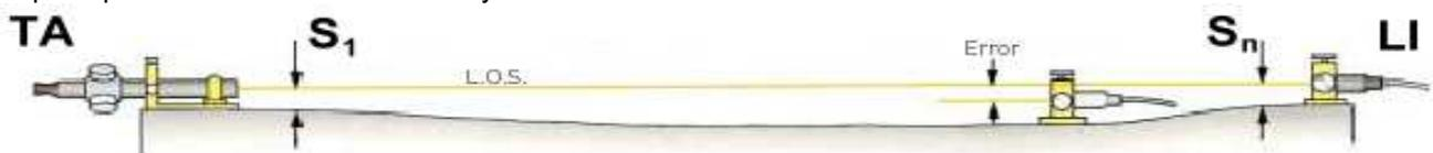
Coloque el telescopio de alineamiento (TA) en un extremo, y enfoque en el blanco del último soporte ( $S_n$ ). Mida luego la distancia que difiere el eje óptico (LOS) en cada soporte, hasta llegar al primer soporte ( $S_1$ ). En casos donde no haya mucha luz, coloque lámparas de iluminación (LI) en la parte trasera del blanco, para iluminarlo mejor. La precisión obtenida es muy alta: por ejemplo, menos de 0.05 mm en distancias de hasta 30m.
